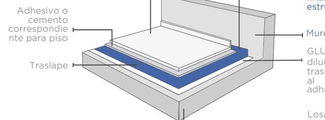
Impact Pro® 3.10 mm: Debe cubrir el 100% de la superficie para impedir el contacto del acabado final de piso con la estructura.
